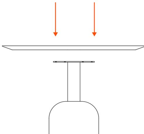
Appoggia il piano sopra la piastra di metallo. | Put the top on the metal plate.
