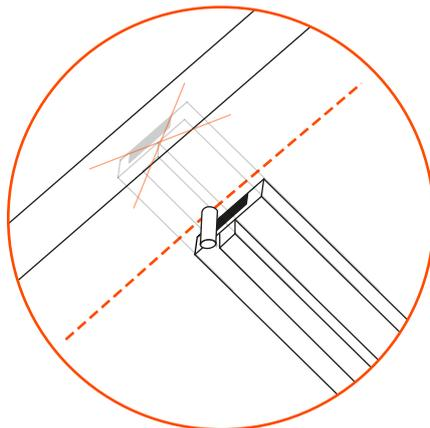
**ATTENZIONE! Sistema di bloccaggio con perno: non oltrepassare!**
