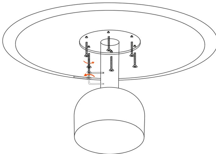
Fissa il piano alla piastra metallica con le viti in dotazione. | Fix the top on the metal plate with the given screws.
