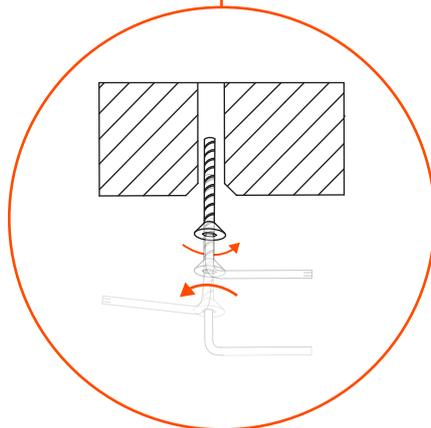
Avvitare ogni piastra nell'apposito foro posizionato sulla fresatura.
