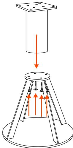
Avvitare la piastra di base alla gamba centrale usando le viti M10x25 in dotazione | Fix the base plate to the central leg with M10x25 screws.
