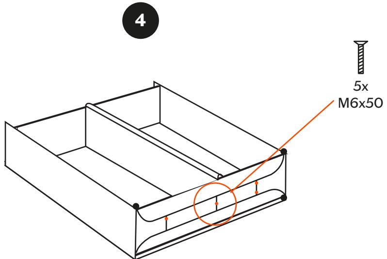
Fissa la base attraverso le apposite asole, utilizzando le viti in dotazione.
