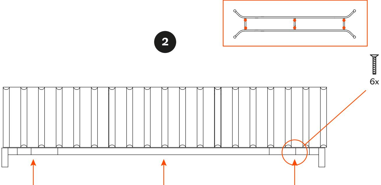
Fissa la base attraverso le apposite asole, utilizzando le viti in dotazione.
