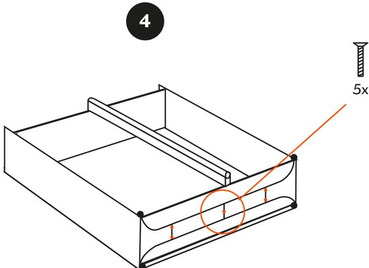
Fissa la base attraverso le apposite asole, utilizzando le viti in dotazione.
