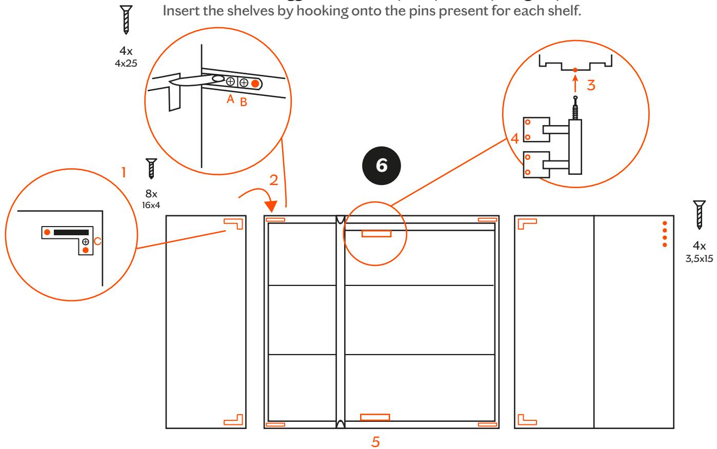
Fissa le cerniere alle ante tramite le 2 viti (1). Quindi inserisci e fissa le ante alla struttura (2).
