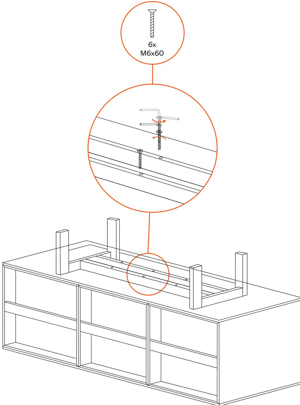
Avvitare la base sul corpo dell'armadio. Fai lo stesso sul lato sinistro della base. | Screw the base to the cabinet's body. Do the same on the left side of the base.
