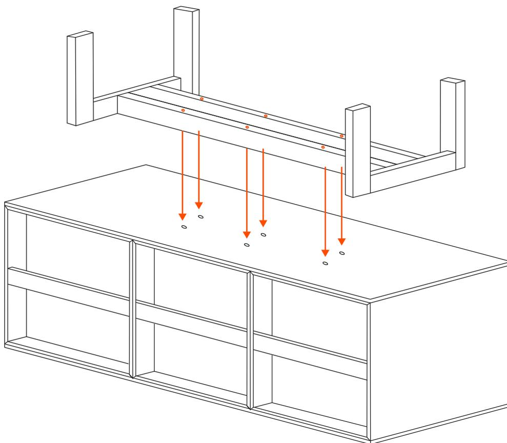
Posizionare la base sul corpo dell'armadio (sottosopra).
