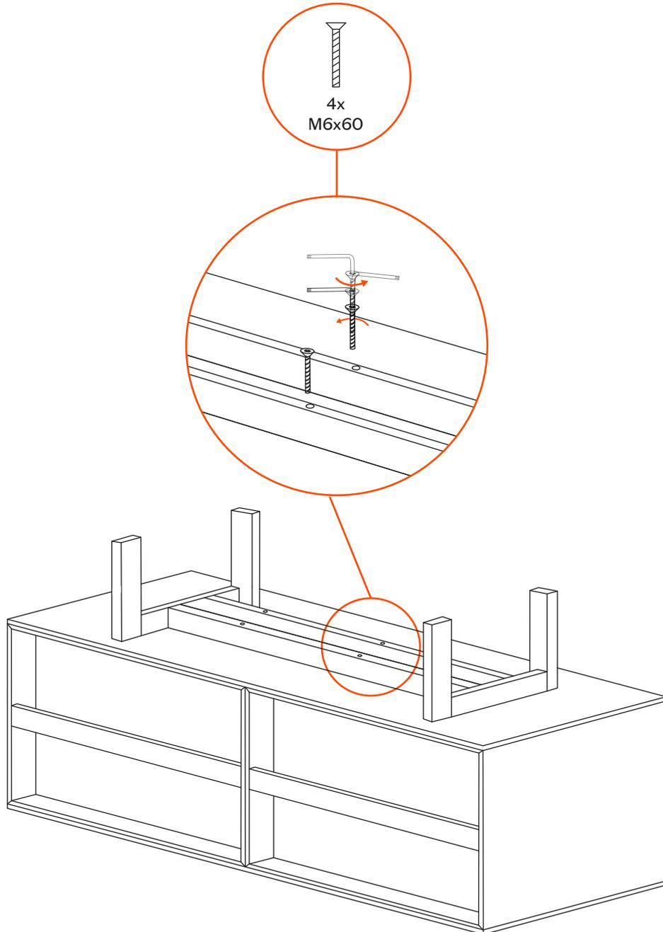
Avvitare la base sul corpo dell'armadio. Fai lo stesso sul lato sinistro della base. | Screw the base to the cabinet's body. Do the same on the left side of the base.
