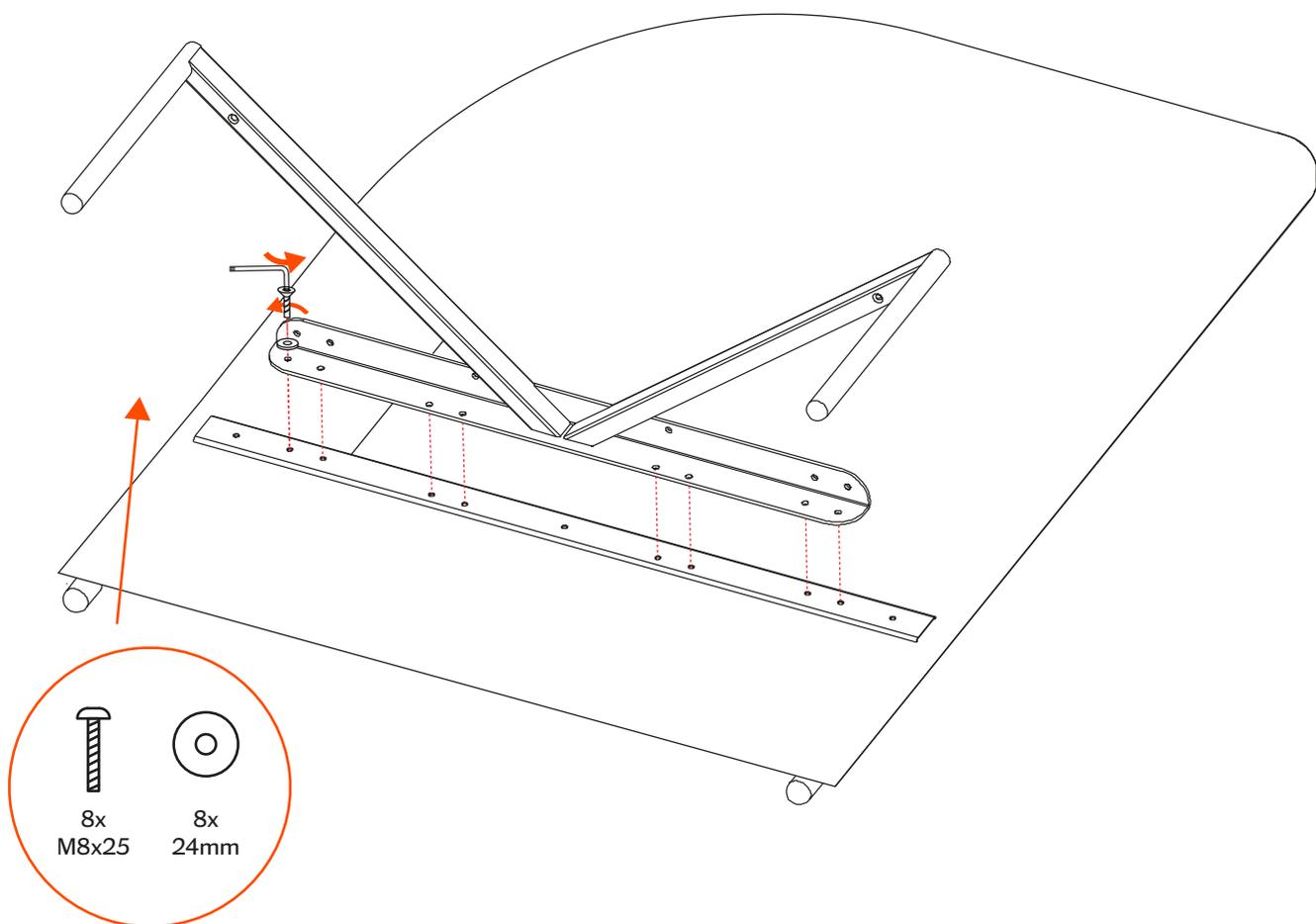
Posizionare le due componenti allineando i fori ed avvitando fino a battuta le viti in dotazione.
