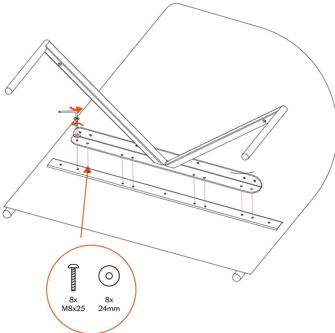
Posizionare le due componenti allineando i fori ed avvitando fino a battuta le viti in dotazione.
