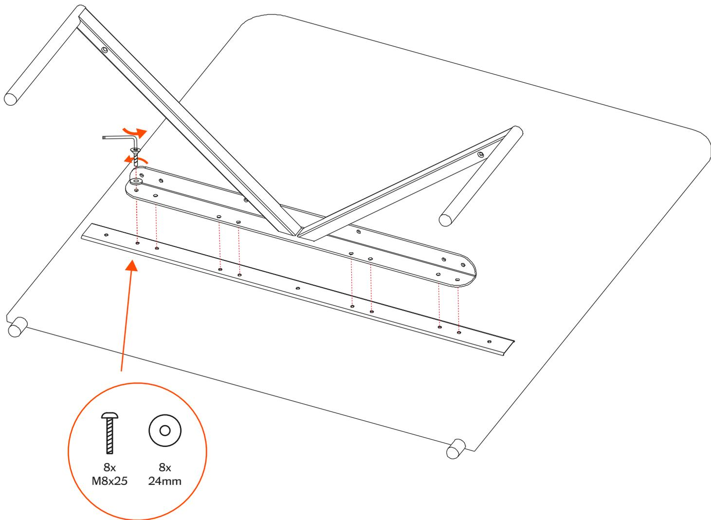
Posizionare le due componenti allineando i fori ed avvitando fino a battuta le viti in dotazione.
